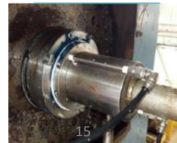
APLICACIÓN SELLADO - CAJA DE RODAMIENTOS
