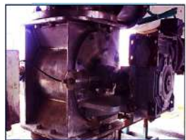
APLICACIÓN SELLADO – VALVULAS ROTATIVAS
