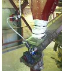
APLICACIÓN SELLADO –TRANSPORTADORES HELICOIDALES
