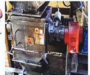
APLICACIÓN SELLADO – SEPARADOR MAGNETICOS ROTATIVO
