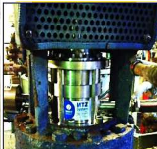
APLICACIÓN SELLADO- REACTOR VERTICAL
