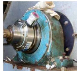
APLICACIÓN SELLADO - CAJA DE RODAMIENTOS
