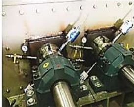
APLICACIÓN SELLADO – MEZCLADOR DE FLECHAS GEMELAS PARA LODOS PESADOS
